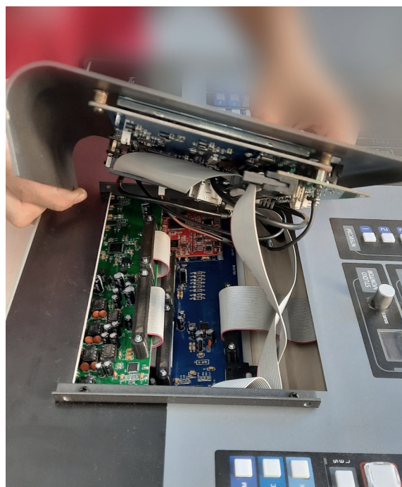
Fig. 11: Levantar cuidadosamente el módulo para desconectarlo
